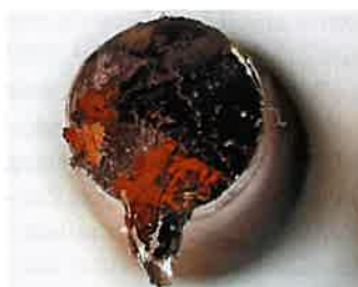
Eine Abriebfahne nach vier Stunden Dauerbetrieb, der Verschleiß am kupferfarbenen Schleiferkohleneinsatz ist deutlich erkennbar. Diese Abnutzung lässt auch eine geringere Standzeit des Produkts vermuten. Immerhin ließ mit zunehmendem Abrieb das Kratzgeräusch nach.
