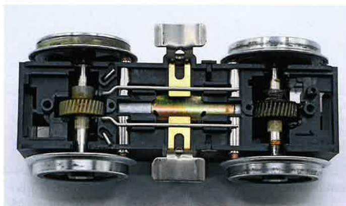
Das unten noch geöffnete LGB B-Getriebe gibt auch den Blick auf die frisch eingebauten Wechsel-Schleiferkohlen frei. Deutlich erkennt man, dass die längeren Hülsen seitlich aus dem Getriebeblock herausstehen.
