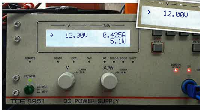
Die Messwerte im lastfreien Betrieb weisen für die Wechsel-Schleiferkohle anfangs einen deutlich höheren Stromverbrauch aus, verbunden mit einer höheren Betriebstemperatur. Im Vergleich dazu zeigt das kleine Bild die Messwerte einer traditionellen Graphit-Kohle ohne Wechseleinsatz.
