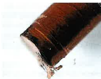
Eine Abriebfahne nach vier Stunden Dauerbetrieb, der Verschleiß am kupferfarbenen Schleiferkohleneinsatz ist deutlich erkennbar. Diese Abnutzung lässt auch eine geringere Standzeit des Produkts vermuten. Immerhin ließ mit zunehmendem Abrieb das Kratzgeräusch nach.
