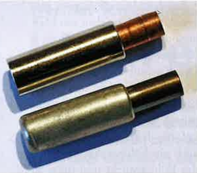
Schleifkohlen der 14-mm-Bauart im Vergleich: oben die Wechsel-Variante von ML-Train mit dem kupferfarbenen Einsatz und längerer Hülse, unten die traditionelle Bauweise mit Graphitkohleeinsatz.
