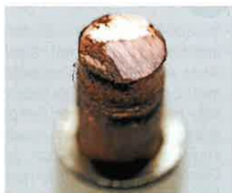
Nachdem die Materialfahnen entfernt wurden, lief das Getriebe erneut drei Stunden. Der weitere Verschleiß des nun kürzeren Kohleneinsatzes ist sichtbar geringer geworden, aber immer noch erkennbar.
