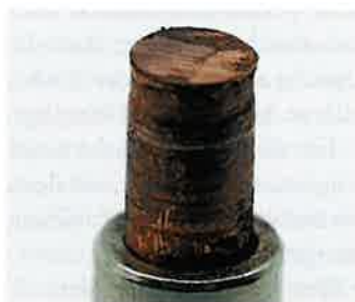
Nachdem die Materialfahnen entfernt wurden, lief das Getriebe erneut drei Stunden. Der weitere Verschleiß des nun kürzeren Kohleneinsatzes ist sichtbar geringer geworden, aber immer noch erkennbar.
